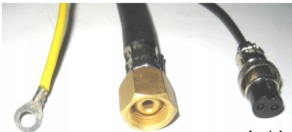
złącze prądowo- gazowe (gumowany przewód gazowy + w środku miedziany przewód prądowy)
